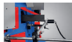
▶ elektromos ütköző (szériakivitelben HPS 55DS-től)
